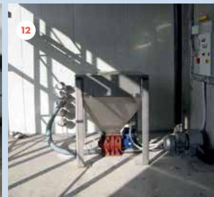
9 Cabine vide sacs pour chargement des silos avec filtre à poussière
