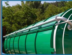
Tubería de carga externa
